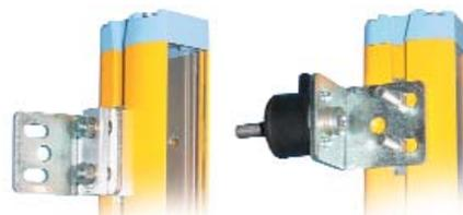
Los soportes de fijación TOP-BOTTOM orientables facilitarán la fase de alineación, incluso bajo las condiciones más críticas, gracias a un ángulo de rotación de 180° y un ángulo de ajuste fino de  $\pm 10^\circ$ . El kit de soportes de fijación se suministra junto con la barrera de luz SG2-E y está disponible como accesorio para la serie completa SG2-B y SG4-B.
